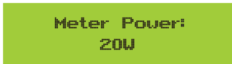
Abb. 7.36 Null-Export-Funktion über Energiezähler einschalten
